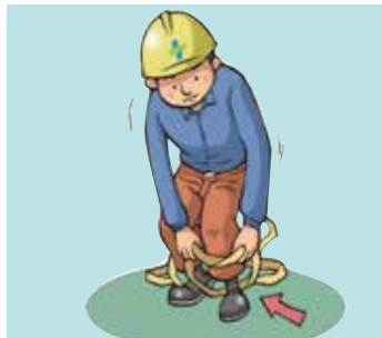
1 Lườn đai an toàn dạng toàn thân vào hai chân và kéo lên
