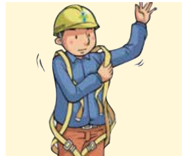
2 Lườn đai an toàn dạng toàn thân vào 2 vai
