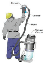
그림 1. 콘크리트 그라인딩에 적합한 이동식 국소배기덮개 (출처: Workplace Solutions, NIOSH 2009)
