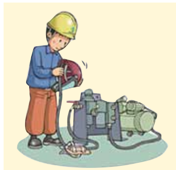
3 중압호스를 유압조절장치 및 여과장치에 연결하고 연결관을 안면부 및 유량조절장치에 연결
