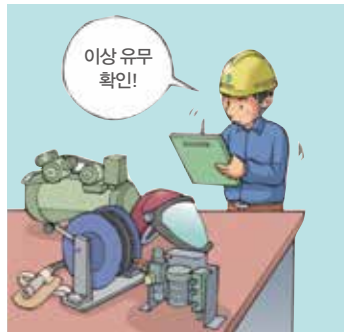
1 압축공기 공급원, 중압호스, 유량 조절 장치, 안면부 등의 이상 유무를 확인
