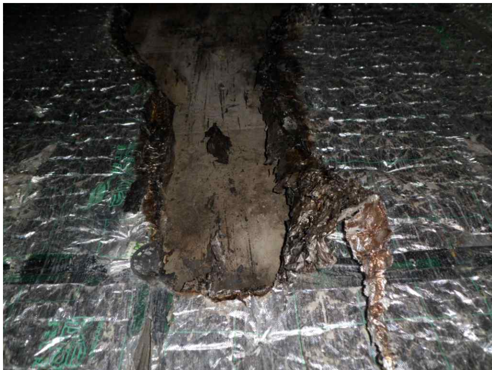
피용단적업중 발생한 불꽃이 최초로 점화된 4-5단 팔레트 부위의 단열재 연소 상태
