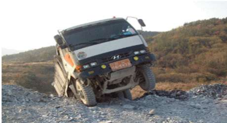
<그림 10> 제동장치 미작동에 의한 미끄럼 사고 사례
