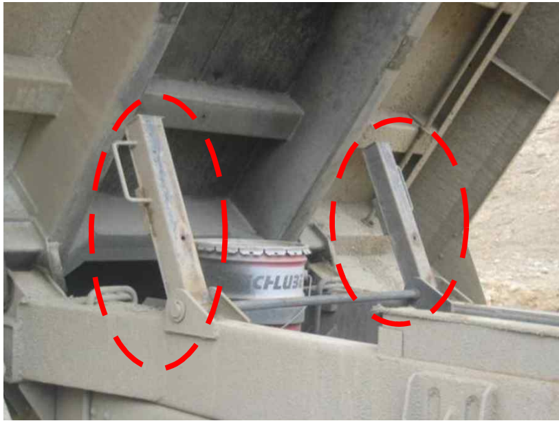
<그림 12> 적재함 안전지주(안전블럭) 설치 사례
