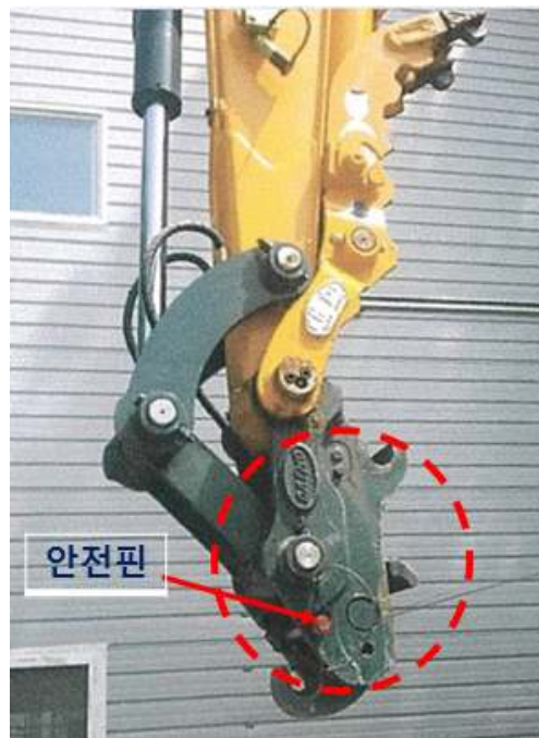
<그림 9> 퀵 커플러 안전핀 설치 상태
